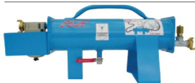
Idéal pour solutionner les problèmes d'humidité rencontrés en sablage. Protège les outils pneumatiques de l'oxydation, du givrage et du colmatage des pertes de rendement. Le tuyau doit être de 20 m au minimum du compresseur à l'épurateur d'air et 3 mètres de tuyau maxi du filtre à la sableuse. Pour une efficacité optimale. Utilisable pour tout débit d'air jusqu'à 2500L / minute. Dimensions : 650 L x 340 h mm. Poids : 13 Kg
