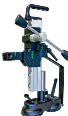
Support à embase à dépression manuelle pour carotteuse portable. Longueur colonne 290 mm. Ø carottage à 90° : 68 mm. Collier de serrage Ø 53 mm.
