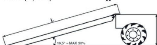
Surface antidérapante. Section des profilés renforcés. Légère. Sécurité grâce au système d'attache.
