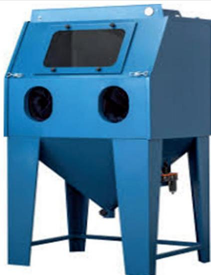
Cabine de sablage industrielle à dépression conçue pour les applications de sablage et microbillage industriel. Tous types de médias de sablage peuvent être employés. Machine polyvalente. Cabine conçue pour utilisation intensive. Livrée montée et prête à fonctionner. Garantie 2 ans (hors pièces d'usure). Autres dimensions et options sur mesure, nous consulter.
