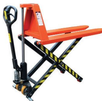
Équipé de 2 stabilisateurs latéraux. 2 vitesses de levage. Capacité 1500 kg. Longueur fourches 1100 mm. Hauteur d'élévation 800 mm.
